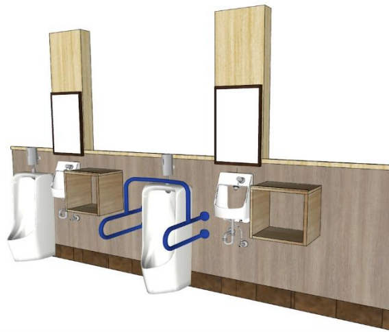
より衛生的に利用できるように便器ごとに手洗器・荷棚を設置
